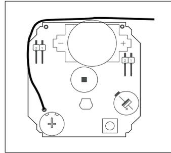
**Zum Einlernen** in einen im Lernmodus befindlichen Aktor oder Professional Smart Home Controller muss die Lerntaste gedrückt werden.
